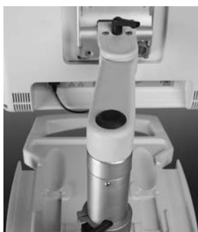
Figura 9 – Ajustar a altura do ecrã táctil
